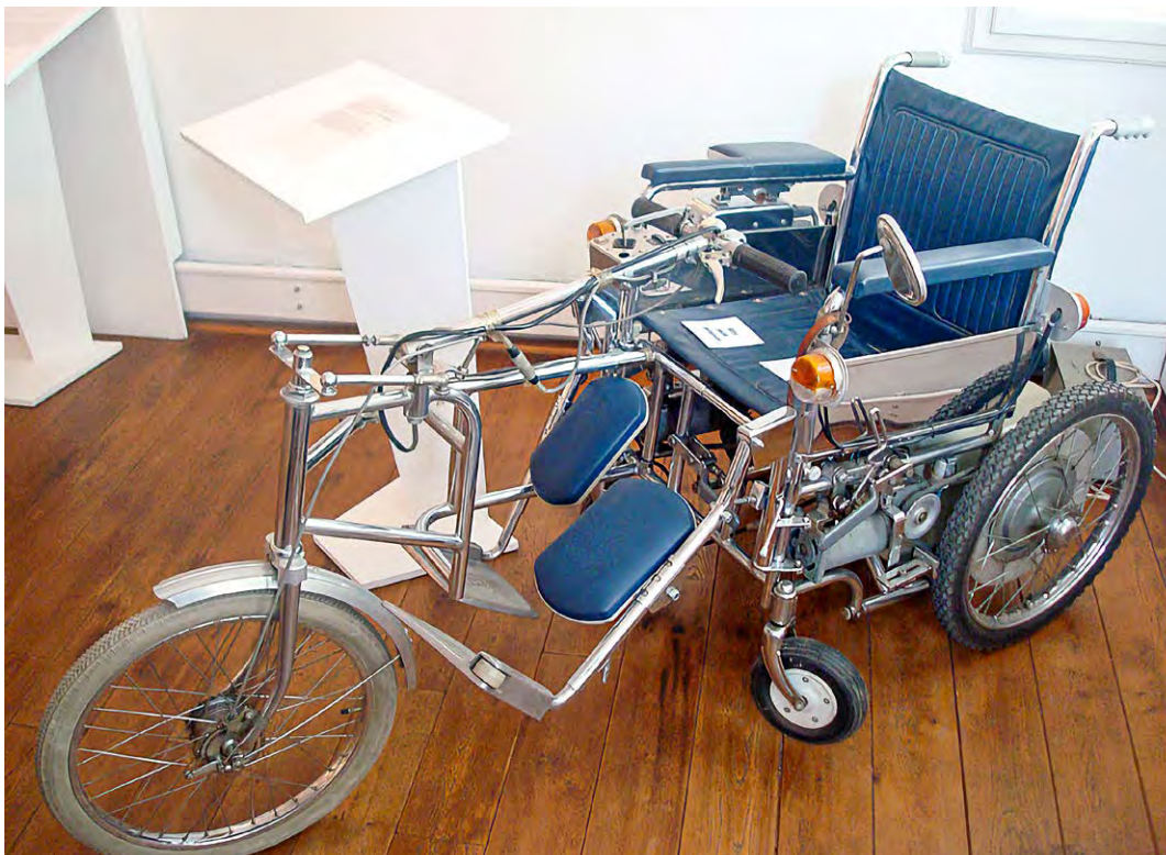
Elektrischer Faltrollstuhl von Everest & Jennings/ Ortopedia GmbH Kiel (Ende der 1960er Jahre) im Stadtmuseum Gütersloh; Langversion für Nutzende, die mit gestreckten Beinen fahren müssen. Separate Elektromotoren treiben die Hinterräder über Keilriemen an.
